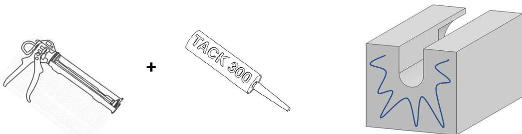
Appliquer de la colle Tack 400 sur la face arrière du Blok
