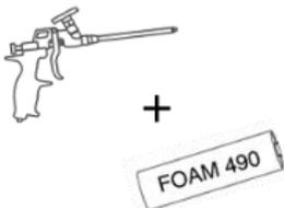
Remplir les lamages de mousse PU jusqu'à la surface du Blok
